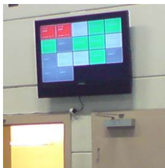
Monitor för visualisering av maskinstatus i verkstaden.
